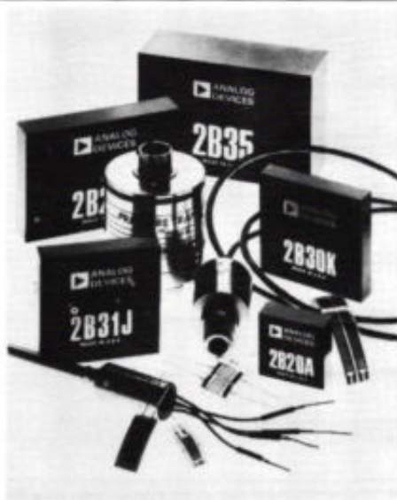
Afb. 21. Voor het meten van de weerstand van transducenten in een industriële omgeving zijn module ontwikkeld die de hiervoor noodzakelijke elektronica bevatten. (foto: Analog Devices)
