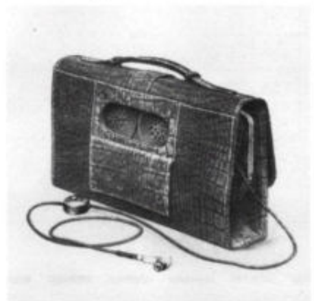
Afb. 3. De Phonophor, een hoorapparaat uit het begin van deze eeuw, dat elegant is ondergebracht in een dametas.
