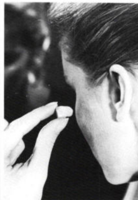
Afb. 5. Het verkleinen van hoortoestellen is nu zo gevorderd dat een compleet hoortoestel in de buitenste gehoorgang kan worden geplaatst.
