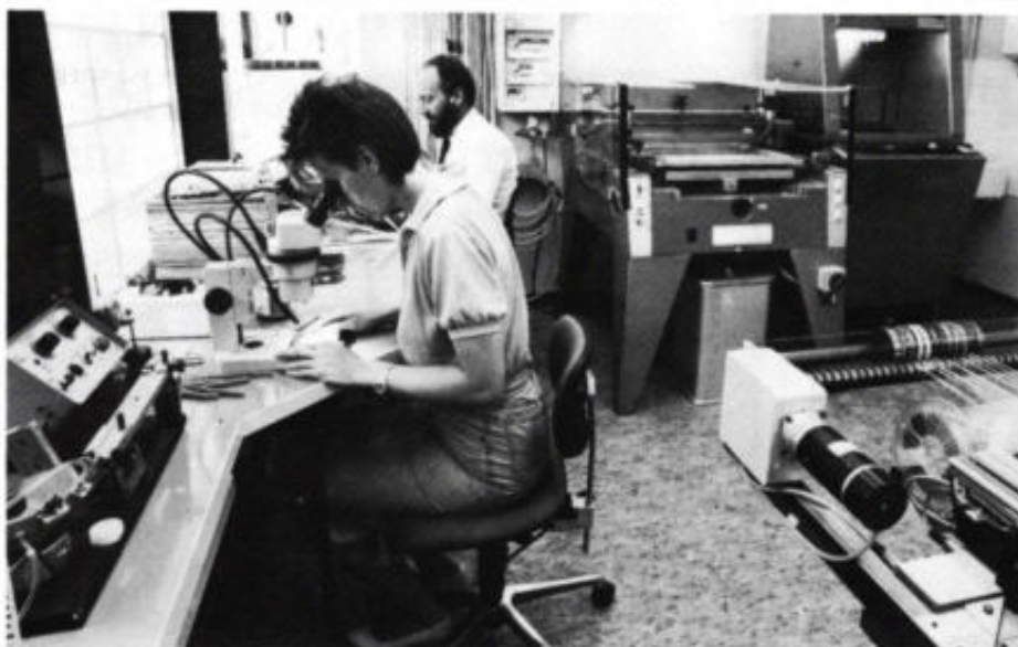
Afb. 1. Kijkje in het applicatielaboratorium voor SMT van Siemens in München. Rechts op de voorgrond is nog net de hanteerautomaat zichtbaar voor het plaatsen van SMD's op de print. Rechts tegen de wand ziet men de gasfase-soldeeroven en links daarvan de zeefdrukinstallatie (foto: Siemens).
