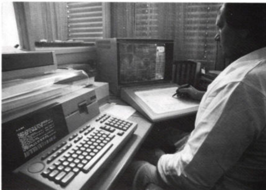
Afb. 2. In een ander hoekje van het SMT-laboratorium staat het CAD-systeem opgesteld, een EGS300 van Hewlett-Packard (foto: Siemens).
