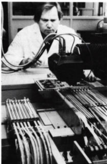
Afb. 3. Voor de productie van proefseries heeft het SMT-laboratorium de beschikking over een HS72-hanteerautomaat (foto: Siemens).
